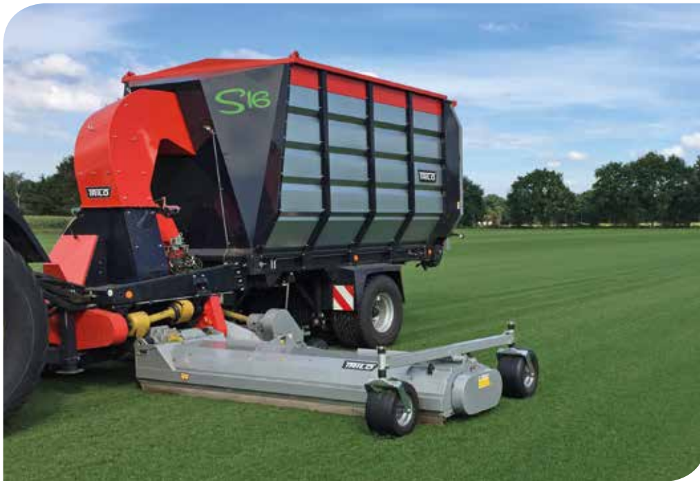
Met de Makkelijk afstelbare tastwielen bepaald u de ideale zuighoogte.
