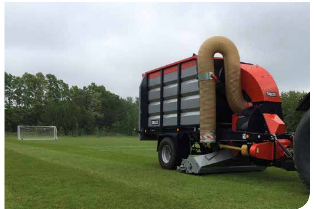
S-Series machines kunnen optioneel worden uitgerust met een zuigslang.
